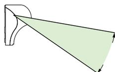
Angle 10° à 35° : Plage de garantie pour les avancées de 1500 mm à 3000 mm.
