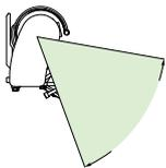
Angle 10° à 70° : Plage de garantie pour les avancées de 1500 mm à 3500 mm.
